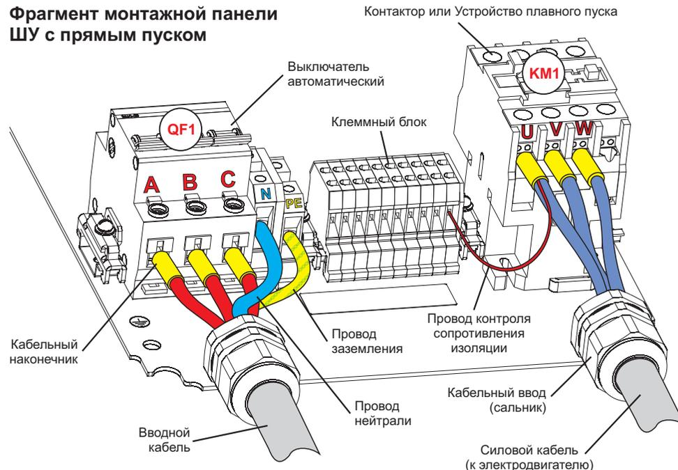
В связи с тем, что микроконтроллер и катушка контактора питаются от сети напряжением ~220В, обязательным условием является подключение провода нейтрали (клемма N).
