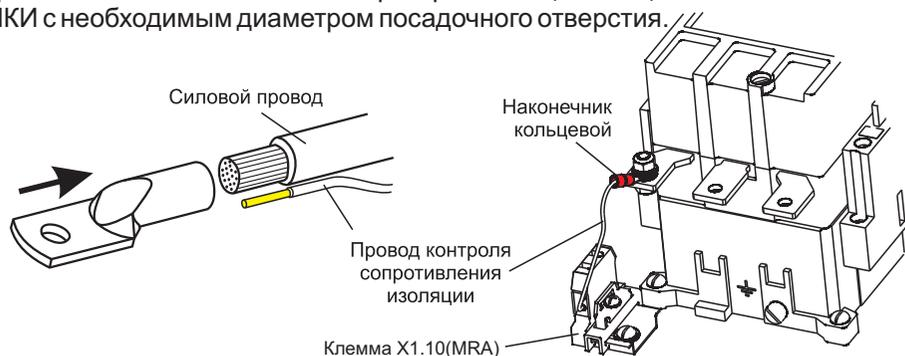
Для исполнений ШУ с плавным пуском подключения провода контроля изоляции не требуется. УПП содержит свою внутреннюю схему контроля изоляции, которая активируется в расширенном меню защит УПП.
