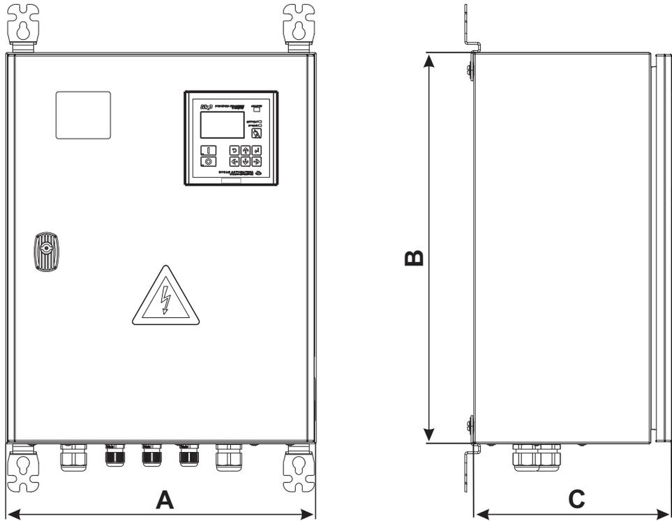
Исполнения ШУ с герметичными кабельными вводами типа PG
