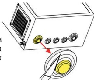
Зачистите концы подключаемых к ШУ силовых кабелей, вставьте их в кабельные наконечники и плотно обожмите соответствующим инструментом (или опаяйте припоем ПОС-61). Силовой кабель рекомендуется применять медный, с необходимым сечением жил.
