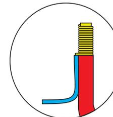
В остальных исполнениях подключение провода осуществляется или совместным обжимом с силовым проводом в кабельном наконечнике, или креплением к клемме контактора при помощи кольцевого наконечника типа НКИ с необходимым диаметром посадочного отверстия.
