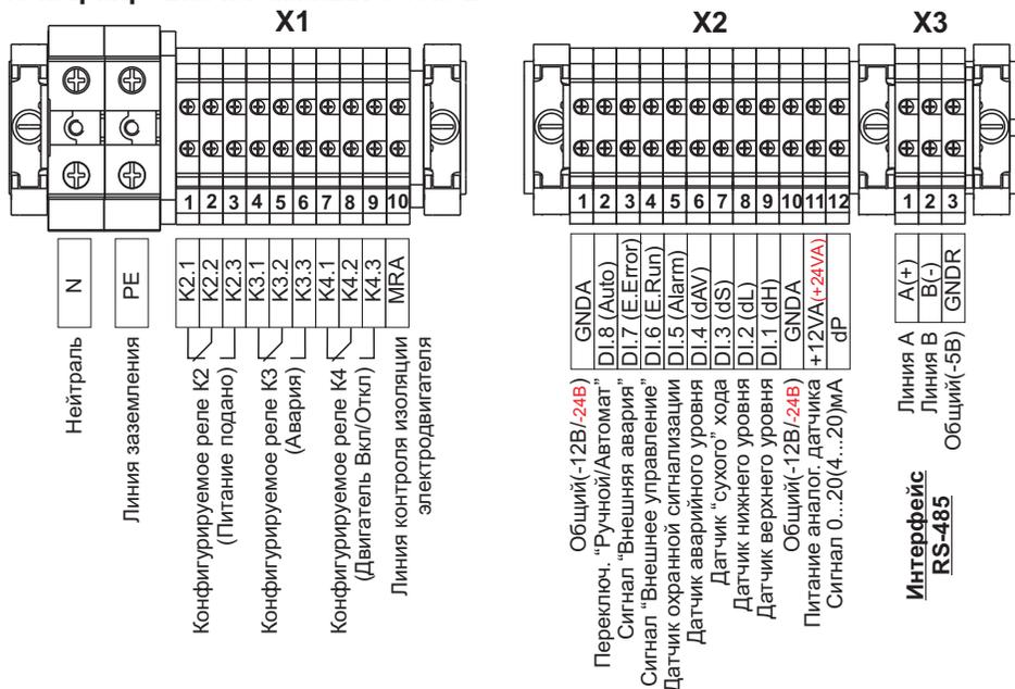
Конфигурируемым дискретным входам DI.1 ... DI.8, выведенным на клеммы X2.2 ... X2.9, возможно присвоить различные сигналы в установочном меню МК3.
