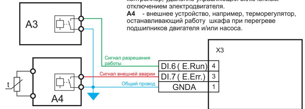
**A3** - внешнее устройство, например, логический контроллер, удаленно управляющий включением/отключением электродвигателя.
